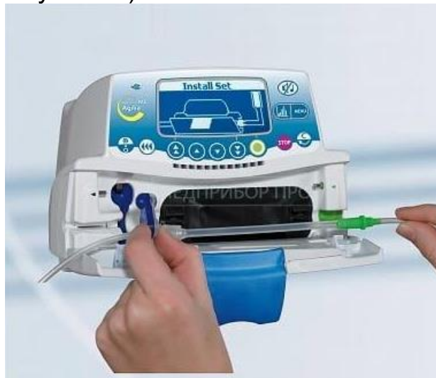
Рисунок 11. Крепление силиконовой вставки системы в инфузомате.
